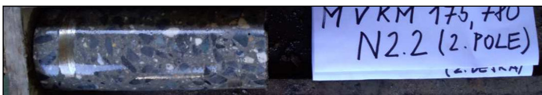
Obr. č. 9- diagnostický návrť do nosné konstrukce 2. pole – N2.2 (2.nosník)
