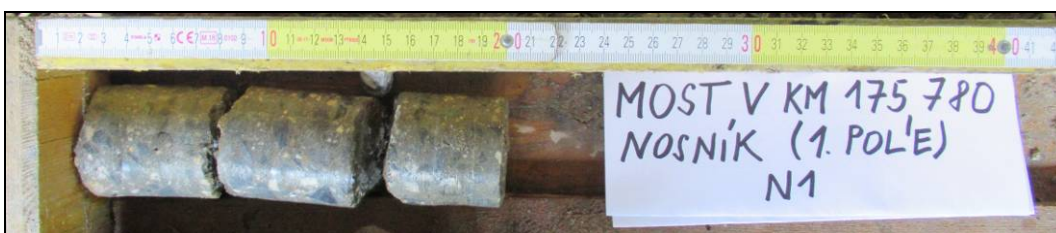
Obr. č. 5 - diagnostický návrť do nosné konstrukce 1. pole – N1.1 (1.nosník)
