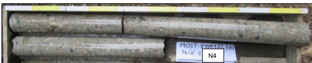
Obr. č. 14 - diagnostický návrť do 1. pilíře – N4 (pilíř 1.1)
