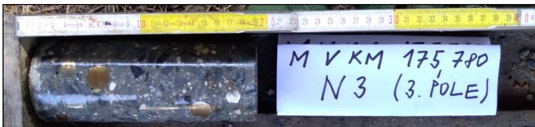
Obr. č. 11 - diagnostický návrť do nosné konstrukce 3. pole – N3.1 (3.nosník)
