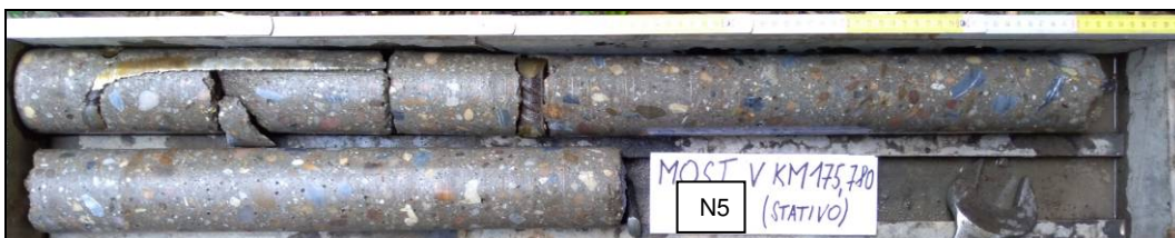
Obr. č. 15- diagnostický návrť do 1. pilíře – N5 (stativo)
