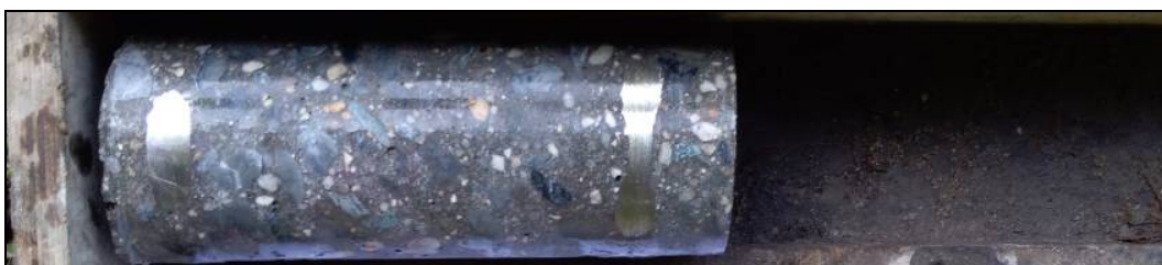
Obr. č. 12 - diagnostický návrť do nosné konstrukce 3. pole – N3.2 (3.nosník)
