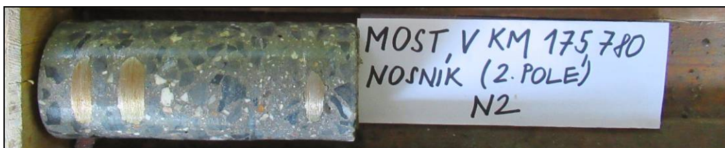
Obr. č. 8- diagnostický návrť do nosné konstrukce 2. pole – N2.1 (2.nosník)
